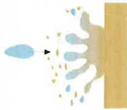
Érosion pluviale ("splash")
