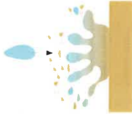
Erosion pluviale ("splash")
